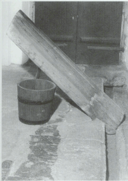
Abb. 3: Ein Gerberbaum/Schertbaum in der Wasserwerkstatt des Lohgerbermuseums zu Dippoldiswalde in Sachsen. Der aus Kiefernholz gefertigte Schertbaum ist 1,30 m lang, 42 cm breit und bis zu 20,5 cm stark. Der kleine Bottich ist 30 cm hoch.
